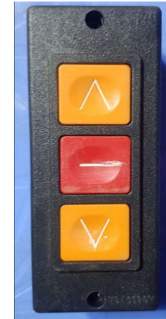
công tắc thường có tiếp điểm stop là thường đóng
